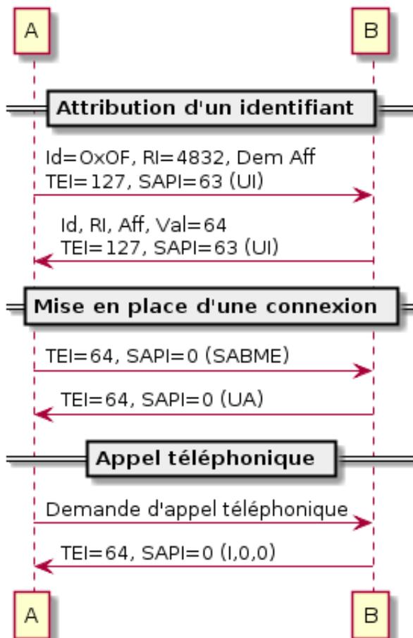
La trame de 8 octets est émise bit par bit sur le canal D. Donc pour deux trames de 88 bits, à 16kbit/s sur le canal D, on aurait un temps de 5,5 ms pour les deux premières étapes.
