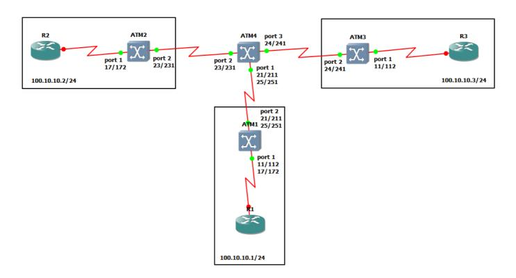
1. De façon similaire à la partie précédente, on complète les tables de commutations des switches ATM. Les commentaires que j'ai ajouté au niveau des switches sur la topologie ci-dessus est une interprétation des tables données en énoncé, afin de configurer correctement tous nos switches ATM :
